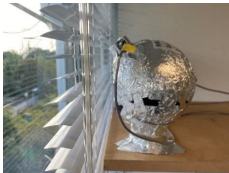
簡易積分球(左：実物 右：断面模式図)
