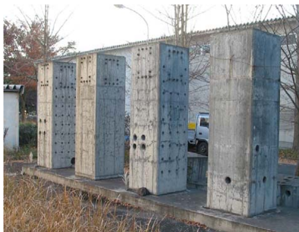
写真 1 高強度コンクリート柱試験体 (右から No.2, No.3, No.4, No.5)
