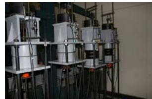
写真 1 クリープ試験の状況
