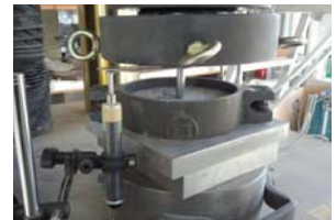
写真 2 耐アルカリ試験の状況
