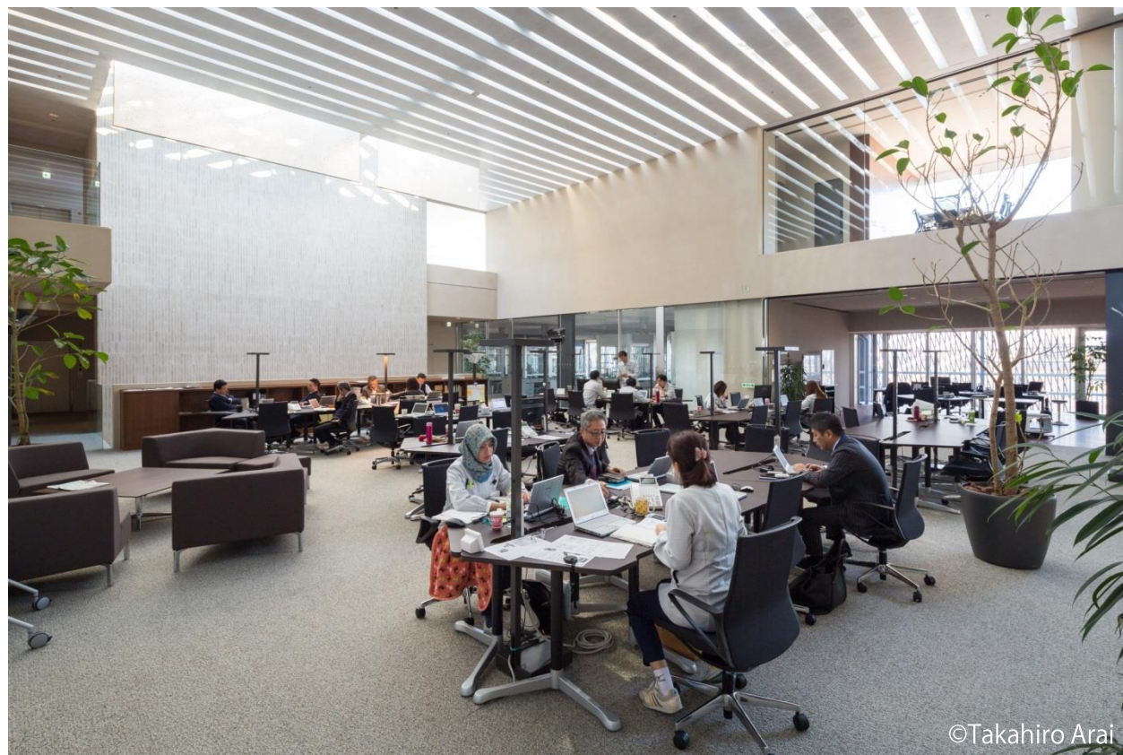
風力換気・重力換気により天井スリット・吹き抜けを通じて建物内に風を導く
