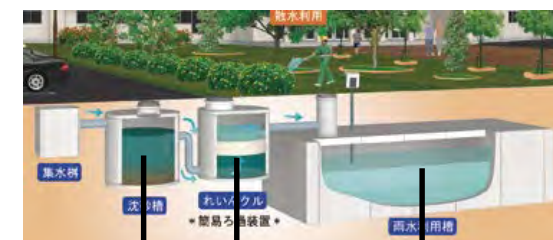
集水槽 沈砂槽 ろ過装置 貯留槽
